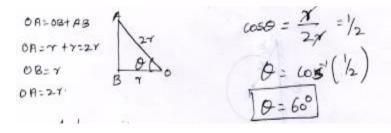
Apply  $\Sigma$ FH=0 R<sub>B</sub>-T<sub>CA</sub> cos 60 = 0------ (1)  $\Sigma$ FV=0 T<sub>CA</sub> sin 60- w=0------ (2)
